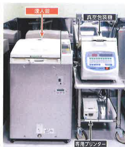
加圧加熱殺菌により常温保存・常温配送が実現。「達人釜」であれば、今後の商品開発においても少量の試作に対応可能。食品ロスの低減にも貢献。↑
