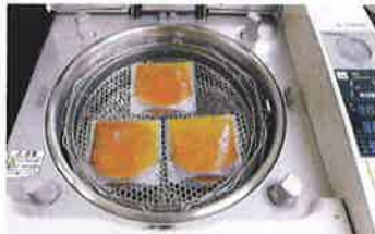
加圧加熱殺菌により常温保存・常温配送が実現。「達人釜」であれば、今後の商品開発においても少量の試作に対応可能。食品ロスの低減にも貢献。↑
